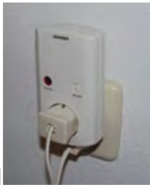
De lampen zijn aangesloten op het Gamma Wave domoticasysteem van Siemens zodat ze draadloos te bedienen zijn
